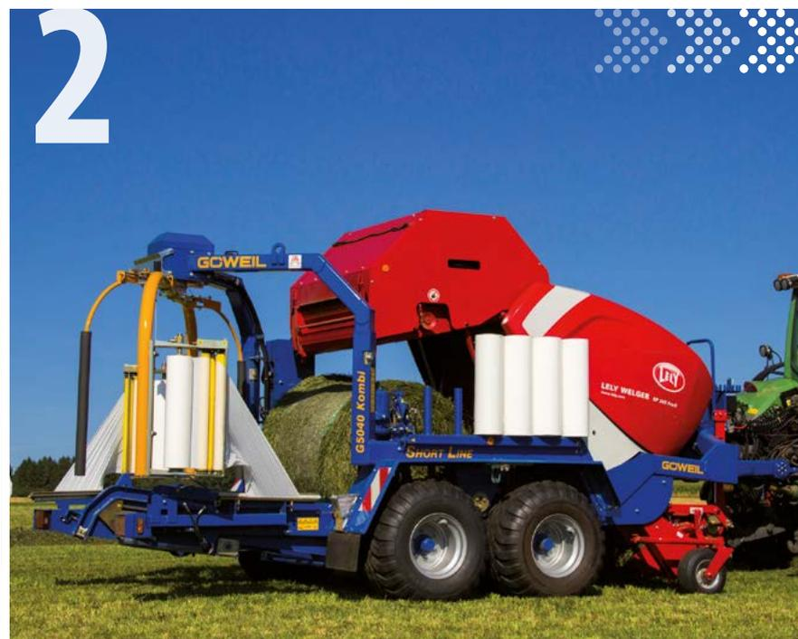
La porte de la presse s'ouvre automatiquement et la balle est transférée directement sur la table. Pendant que celle-ci se déplace en position d'enrubannage, la porte se referme simultanément. Le temps de transfert est réduit à un minimum.
