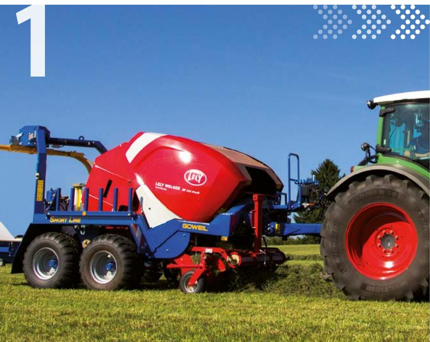
La prise du fourrage se fait à l'avant par le Pickup - le pressage et le liage de la balle sont commandés par la presse. La table d'enrubannage se positionne pour le transfert dès que le liage débute.
